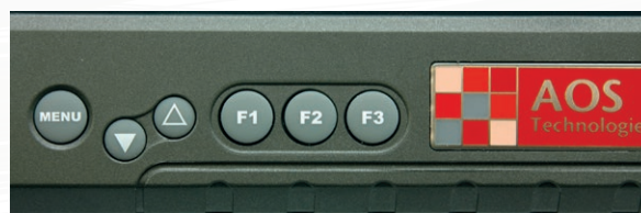
Dedizierte Bedienelemente für den schnellen Zugriff auf Menü, Belichtungszeiten und benutzerspezifische Kameraeinstellungen
